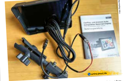
Hier sieht man, wie das USB-Stromkabel nachträglich an das System angeschlossen wurde.
